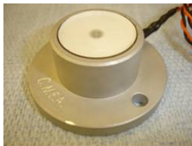
Figura 14 - Solarímetro fotovoltaico desarrollado por el DES.
