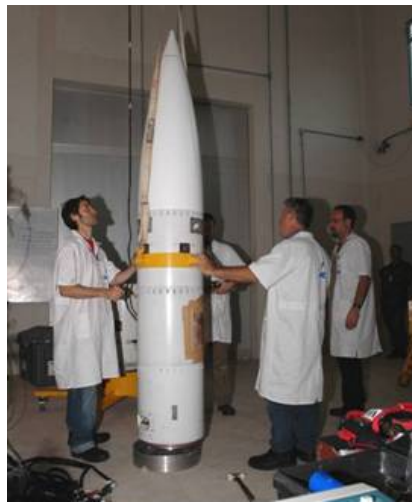
Figura 7 - Cofia del cohete VS-30. Arriba de la faja amarilla se observan dos de los cinco soportes de sensores apareados.
