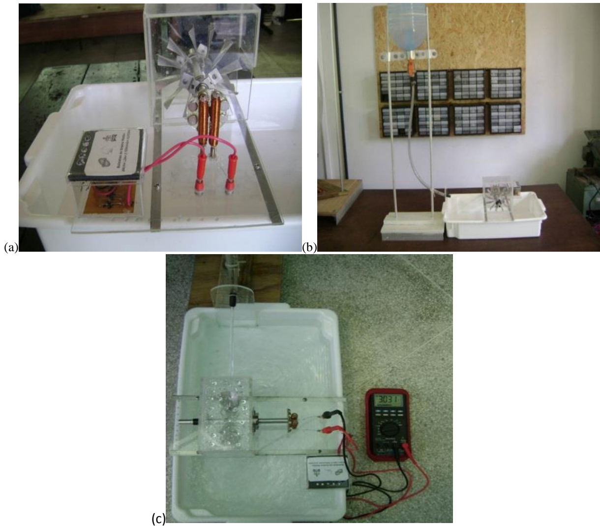
Figura 1 – Protótipo de uma PCH: (a) Kit completo; (b) Gerador e carga e (c) Geração de energia.
