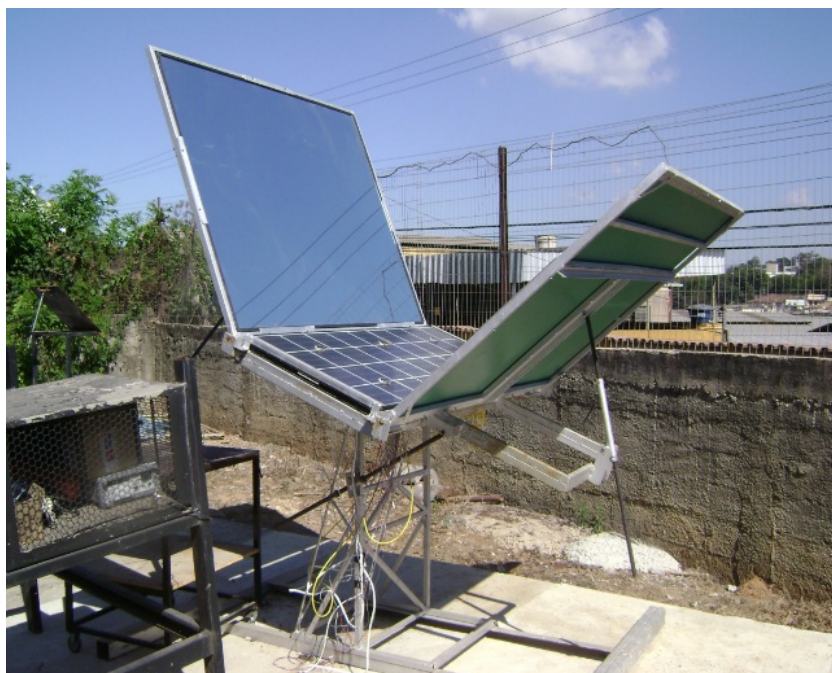
Figura 6 - Plataforma de testes mostrando a estrutura, o coletor tipo “V” e o painel fotovoltaico testado.
