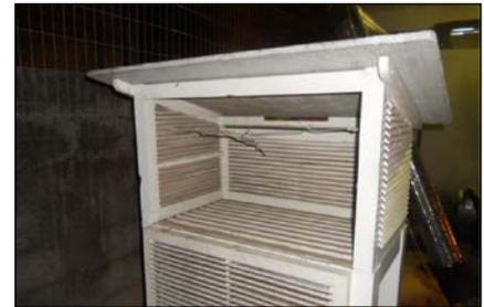
Figura 7c – Abrigo do termopar “T”.
