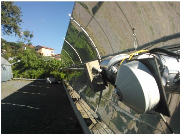
Figura 6 – Piranômetro instalado na linha dois no plano de abertura do coletor.
