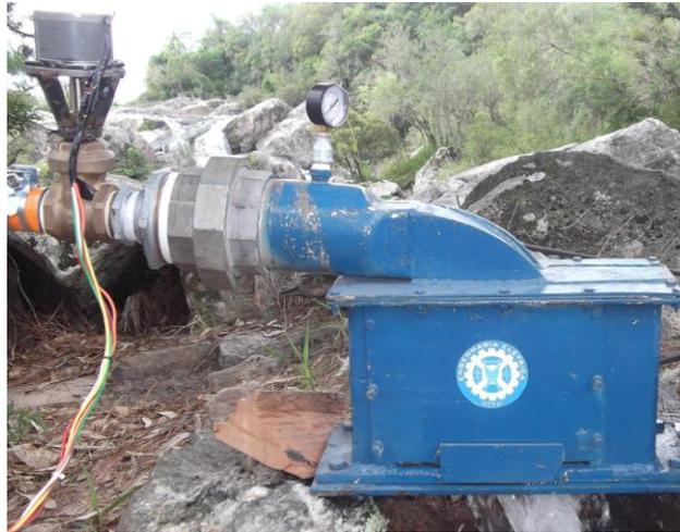
Figura 5 - Turbina Tipo Banki.
