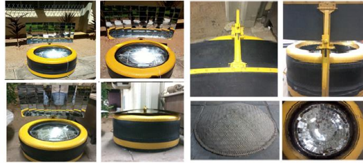
Figura 2. Etapas do processo de montagem do forno solar tipo caixa fabricado.
