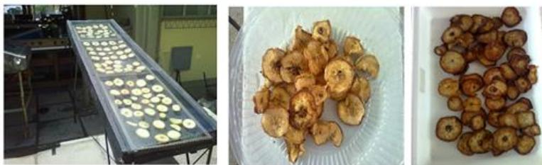
Figura 6. Secador solar fabricado em material compósito.
