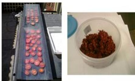
Figura 5. Secador solar fabricado em material compósito partir de um molde de sucata de luminária.
