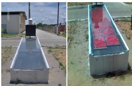
Figura 1. Sistema de secagem em convecção natural ou forçada para a secagem de tomate.
