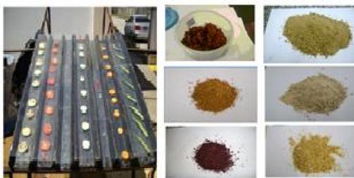
Figura 3. Alimentos em processo de secagem no secador e as farinhas produzidas a partir das frutas secas.
