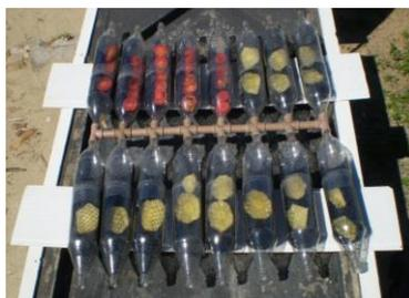
Figura 4. Secador solar fabricado com garrafas PETS.
