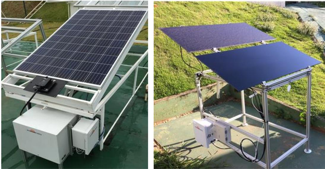
Figura 1- Estações de monitoramento de sujidade instaladas no laboratório GREEN PUC Minas, em Belo Horizonte, Minas Gerais. Esquerda: tecnologia silício cristalino (módulo Canadian Solar 265W). Direita: tecnologia de filme fino telureto de cádmio (módulo First Solar 110W).
