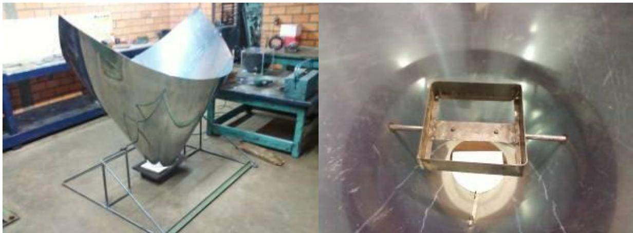
Figura 3 - Suporte do cone e do acumulador térmico.
