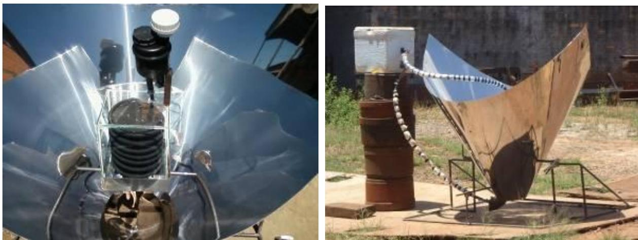
Figura 1 – Coletor solar de funil, com detalhes de seu interior (esquerda) e instalado para teste (direita).
