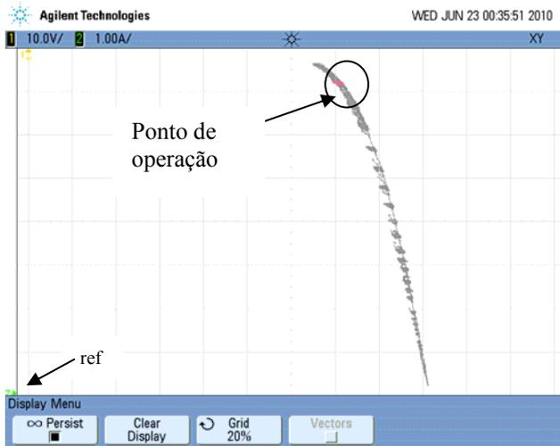
Figura 5 – Resultado experimental da Curva  $V_{pv}(\text{ch1})$  10 V/div x  $I_{pv}(\text{ch2})$  1 A/div para a Condição 1.
