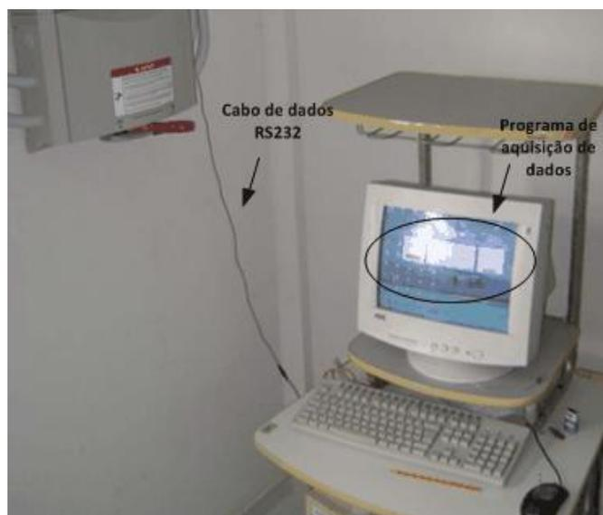
Figura 5- Sistema de aquisição dedicado ao SFCR.
