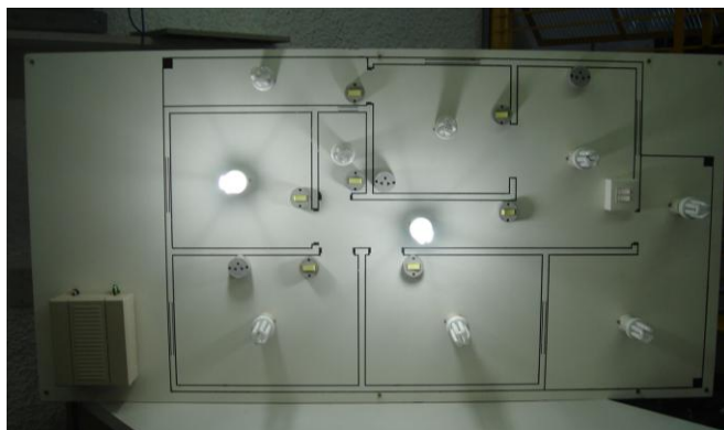
Figura 4- Carga local representando uma residência popular em escala reduzida (Carvalho et al. , 2008).
