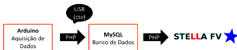
Figura 6- Esquema simplificado da importação do arquivo CSV para o banco de dados MySQL .
