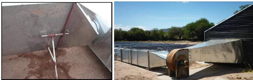
Figura 3: Sistema de rotación de colectores. Figura 4: Acople de caño maestro a motor.
