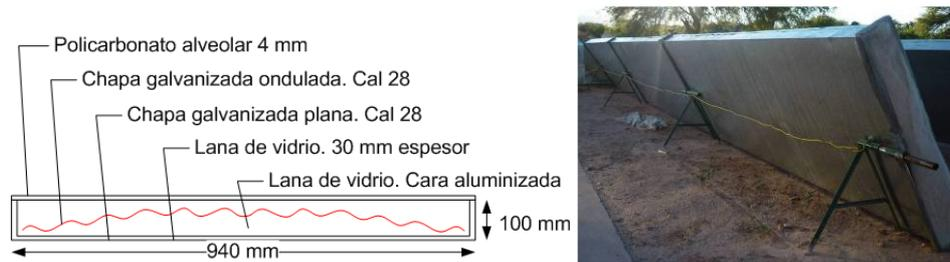
Figura 2: Sección transversal del colector solar de aire, donde se aprecian los elementos constituyentes.
