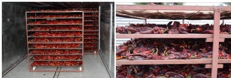
Figura 7: Carro con carga de producto fresco dentro del secador. Figura 8: Detalle de bandeja con producto seco.
