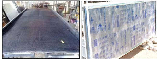
Figuras 2 - (A) Colocación del material poroso como absorbedor, (B) Colector terminado con cubierta protectora.
