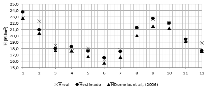
Figura 2 – Comparação entre medição real, resultado estimado e resultados obtidos pelo modelo de Dornelas et al. , (2006) para a radiação global média do ano de 2014
