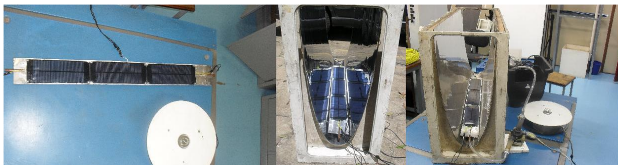
Figura 3 - Montagem dos painéis e trocador de calor.
