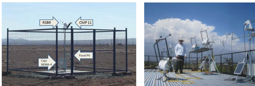
Figura 3 – Estaciones RSBR y adicional CMP11 (izquierda); Laboratorio de Evaluación Solar PUC (derecha)
