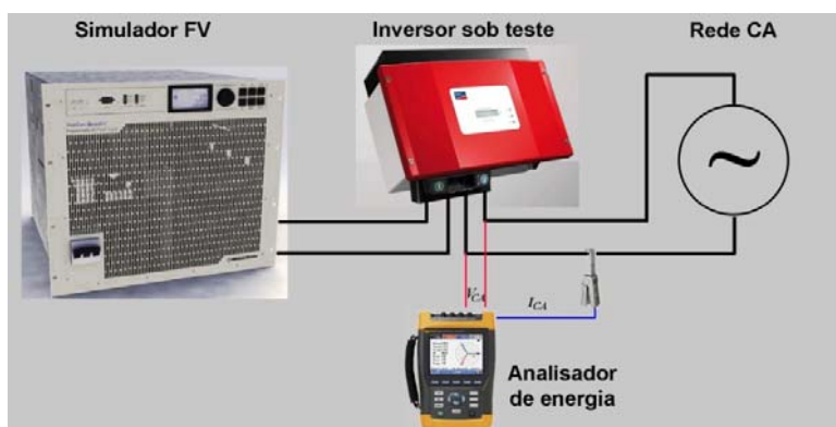
Figura 4 - Bancada de testes para o ensaio dos inversores.
