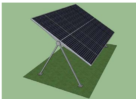
Figura 10 – Estrutura articulada do protótipo de seguidor solar de um eixo.
