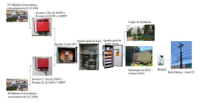
Figura 3- Diagrama representativo da instalação do SFCR do IFCE-Campus Cedro.
