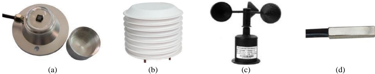
Figura 2 – Sensores utilizados no sistema de monitoramento: (a) piranômetro; (b) sensor de temperatura ambiental; (c) anemômetro; (d) sensor de temperatura dos módulos.
