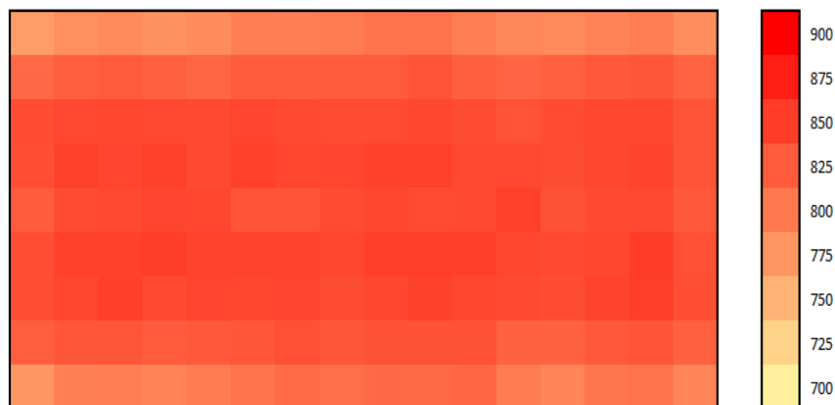
Figura 14 - Resultado do mapa de não-uniformidade medido após o reposicionamento da lâmpada como indicado na Fig. 13. A irradiância máxima obtida foi de 850 W/m 2 , mínima de 769 W/m 2 , e média de 831 W/m 2 resultando em uma Não-uniformidade de 5,02%, atribuindo uma classificação “C” muito próximo à classificação “B”.
