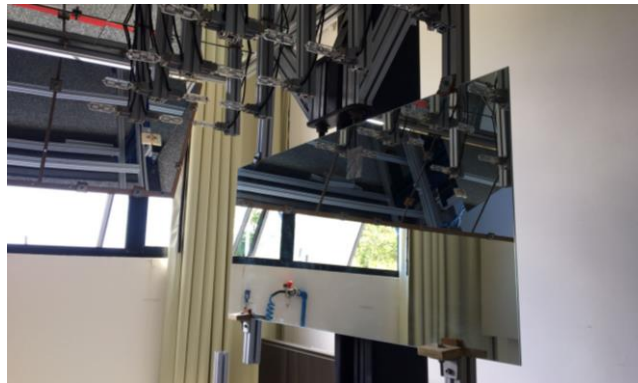
Figura 10 - Espelhos verticais instalados nas extremidades do simulador para aumentar a irradiância nas bordas ao longo dos 2 m do plano de teste.
