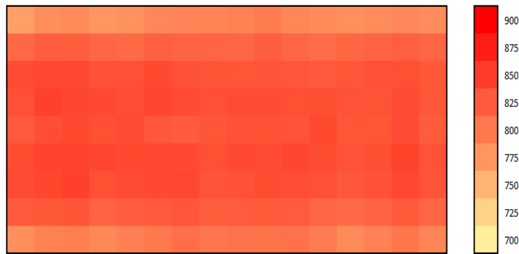
Figura 16 - Resultado do mapa de não-uniformidade medido após a rotação das lâmpadas como indicado na Fig. 17. A irradiância máxima obtida foi de 846 W/m 2 , mínima de 768 W/m 2 , e média de 826 W/m 2 resultando em uma Não-uniformidade de 4,87%, atribuindo uma classificação “B”.
