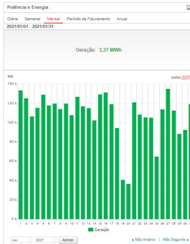
Fig. 5 – Geração no mês de janeiro de 2021. Fonte: Software Monitoramento SolarEdge.
