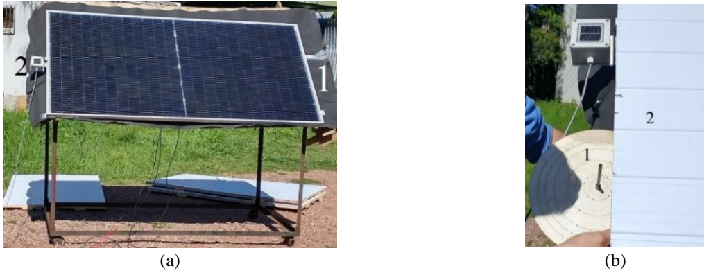
Figura 3 – (a) Módulo acomodado na estrutura, mostrando o detalhe da cobertura posterior do módulo (1) e a célula de referência (2) e (b) gnômon (1) e cobertura frontal (2).
