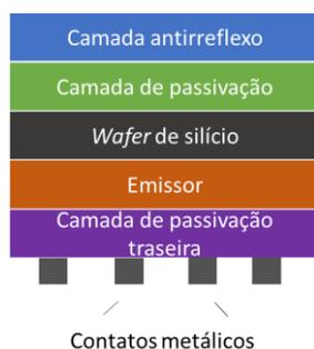
Figura 4 - Esquema de construção da célula IBC. Fonte: Elaborado pelos autores.
