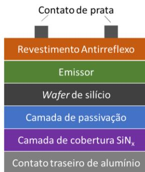
Figura 1 - Esquema de construção da célula PERC. Fonte: Elaborado pelos autores.
