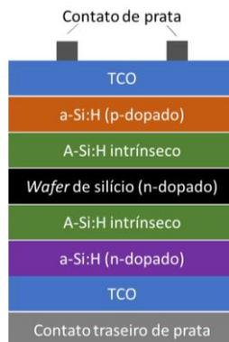
Figura 3 - Esquema de construção da célula HJT. Fonte: Elaborado pelos autores.
