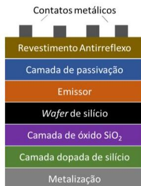
Figura 2 - Esquema de construção da célula. Fonte: Elaborado pelos autores.
