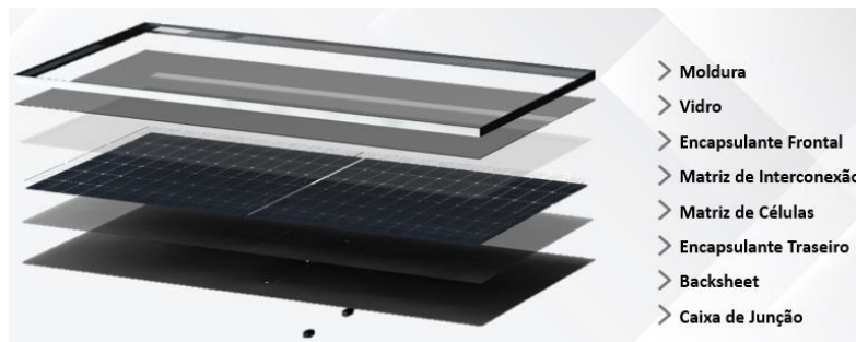
Figura 2 - Estrutura do módulo fotovoltaico convencional.
