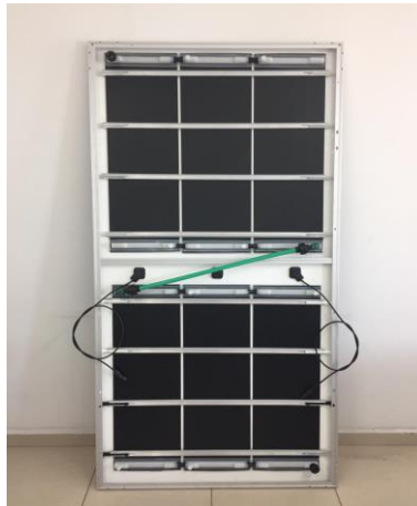
Figura 1 - Módulo FVT com trocador de calor de PP.
