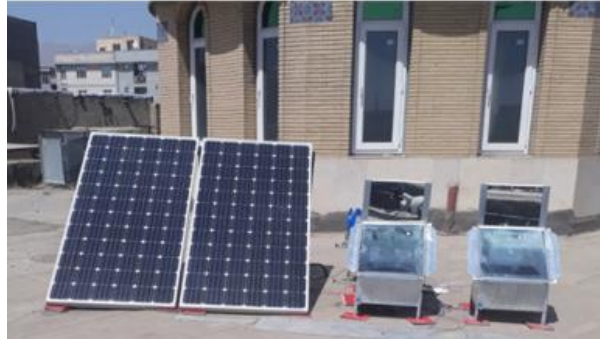
Figura 8 – Dessalinizadores solar termoelétrico movido a energia renovável com condensador externo. Fonte: Parsa et al. (2020).
