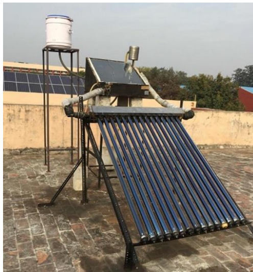
Figura 9 – Dessalinizador solar com refletor parabólico combinado com coletor de tubo evacuado. Fonte: adaptado de Bhargva e Yadav (2020).
