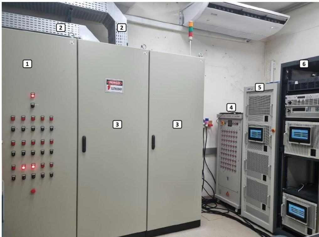
Figura 4 - Microrrede LabREI e equipamentos. Legenda: 1) Painel de controle; 2) Eletrocalha para cabos elétricos; 3) Painéis com barramentos; 4) Banco de cargas RLC; 5) Conversor bidirecional NHR-9410; 6) Rack com fontes CC e cargas CA programável NHR-9430 (Ota e Pomilio, 2021).
