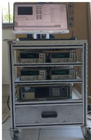
Figura 7 – Traçador de curvas de corrente e tensão.
