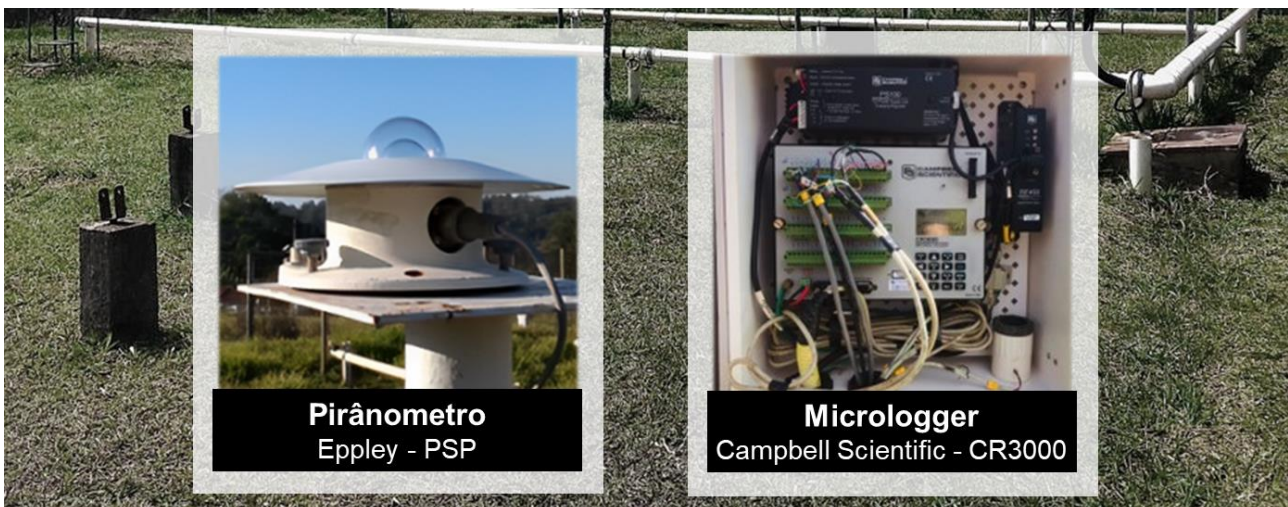
Figura 1 - Instrumentos da Estação de Radiometria Solar da Faculdade de Ciências Agrônomicas da Universidade Estadual Paulista “Júlio de Mesquita Filho” - UNESP de Botucatu (SP) - Brasil.
