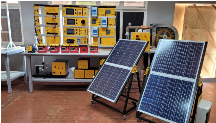
Figura 3 – Bancadas de Sistemas de Energia Solar on e off grid
