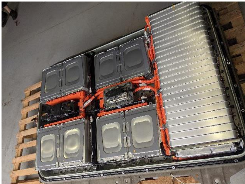
Figura 1 - Conjuntos de baterias do Nissan LEAF aberto (Hohmann; Oliveira; Rütther, 2022).
