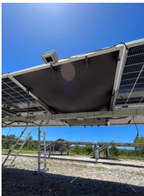
Figura 3 – Módulo FV com lado posterior coberto por EVA preto, garantindo uma irradiância menor que 3 \text{ W/m}^2 na parte posterior do módulo FV e assim, simulando uma condição monofacial.
