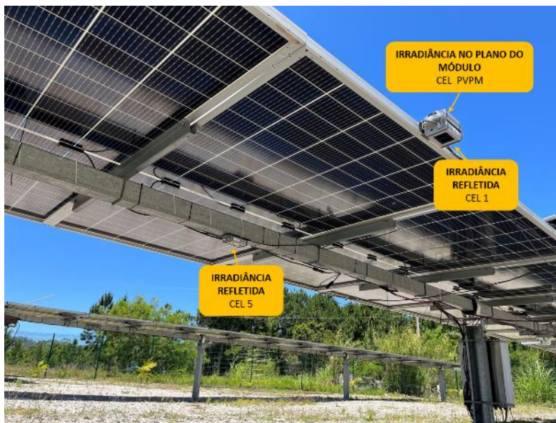
Figura 1 – Disposição das células de referência utilizadas para medição de irradiância no momento dos ensaios.
