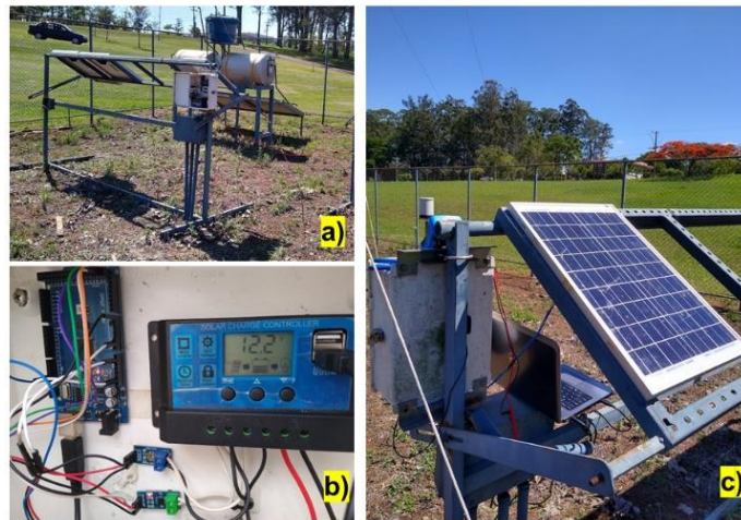
Figura 4 - Montagem experimental. Suporte com módulo fotovoltaico, (b) Instalação da instrumentação e sensores, (c) Arranjo de equipamentos montados.
