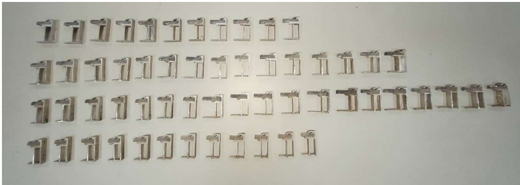
Figura 4 - 57 corpos de prova classificados por fileiras correspondendo sua posição no módulo, de cima para baixo: parte superior, parte esquerda, parte direita e parte inferior.
