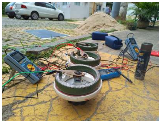
Fig. 2 - Circuito com três reostatos e medidores para teste com carga variável.
