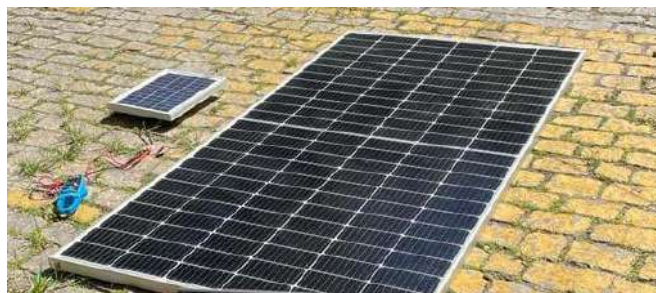
Fig. 3 - Módulo de referência à esquerda utilizado nos ensaios ao lado do módulo rígido.
