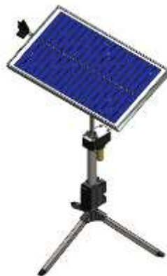
Figura 3 - Vista isométrica do protótipo de rastreador solar desenvolvido (Fonte: Autores, 2023).
