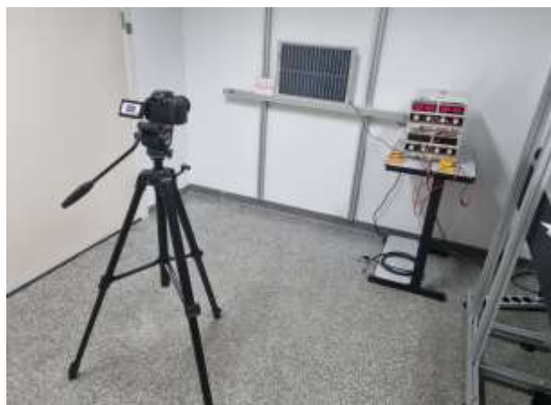
Figura 1 - Sistema de detecção de emissão de eletroluminescência. Câmera fixada em tripé, conjunto de fonte de alimentação elétrica e suporte fixado na parede com painel sob teste.
