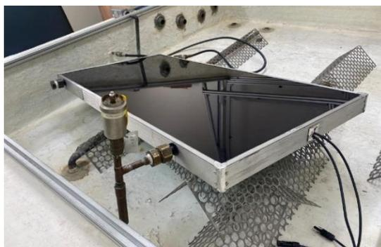
Figura 5 - Bancada de teste de pressão interna.
