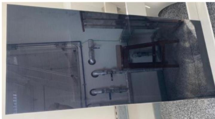
Figura 4 - Módulo fotovoltaico de Telureto de Cádmio do protótipo PVT 2.
