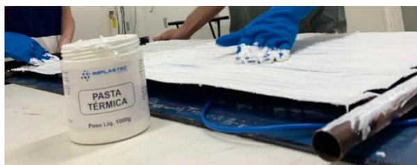
Figura 8 - Aplicação da pasta térmica no protótipo 1.
