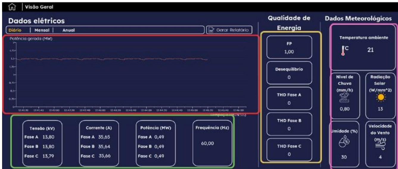
Figura 5: Supervisório da usina em funcionamento
