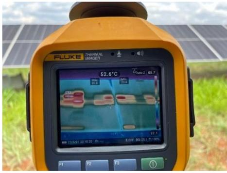
Figura 9. Termografia de módulos fotovoltaicos usando a câmera infravermelha Fluke Ti450.
