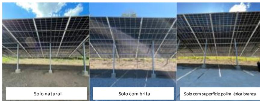
Figura 12. Estudo de diferentes coberturas de solo para efeito de albedo em fileiras de módulos bifaciais da Usina Solar Itaguara: Solo natural; Solo de brita; Superfície polimérica branca.
