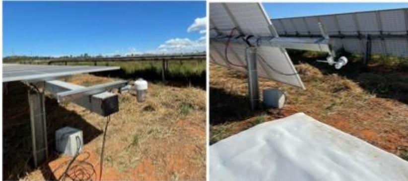
Figura 10. Medição comparativa do albedo em Três Marias: Esquerda – Cobertura natural do solo; À direita – camada polimérica branca.
