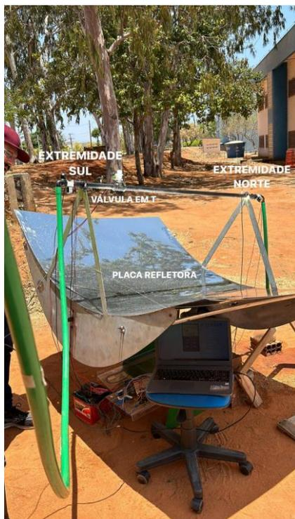
Figura 1 - Estrutura e inclinação da calha. (Autoria própria)
