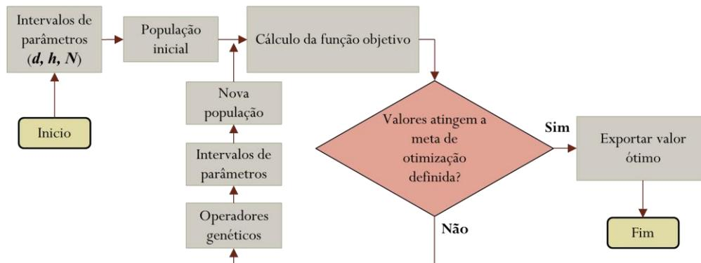
Figura 4: Fluxograma do processo de otimização realizado por um algoritmo genético na obtenção de soluções otimizadas para o problema de geometria retangular de dedos coletores.
