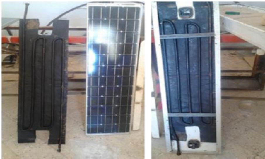
Figura 5 – Sistemas fotovoltaico e térmico, separados e ligados.
