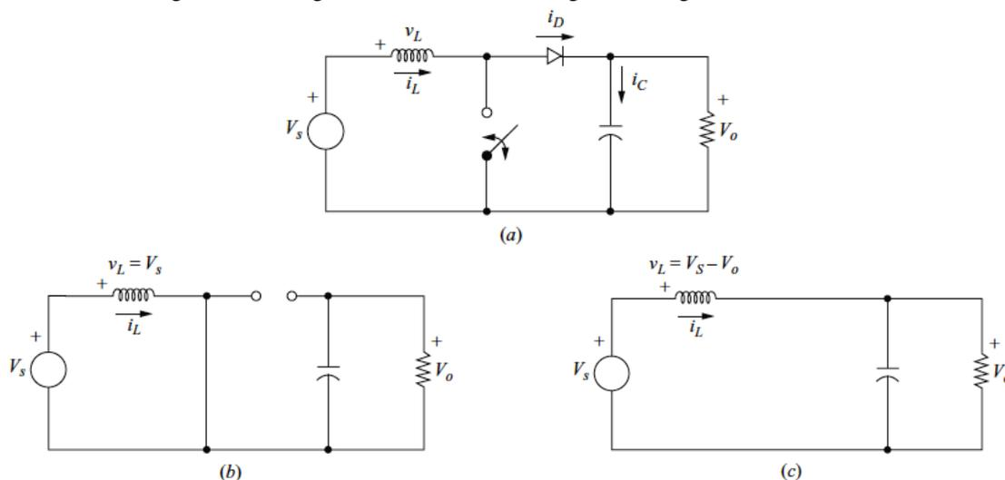
Figura 1. (a) Conversor *Boost*. Circuito equivalente para: (b) chave fechada e (c) para chave aberta. Fonte: [7].
