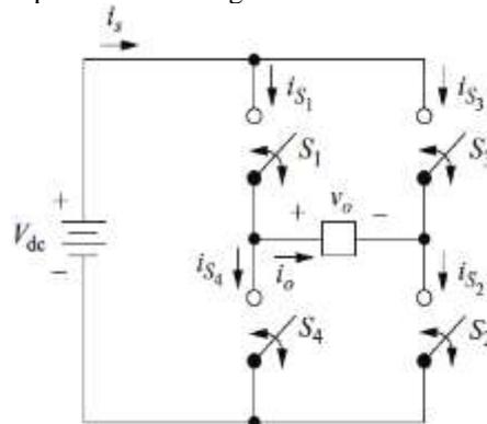
Figura 2 - Conversor Ponte Completa Monofásico. Fonte: [7].
