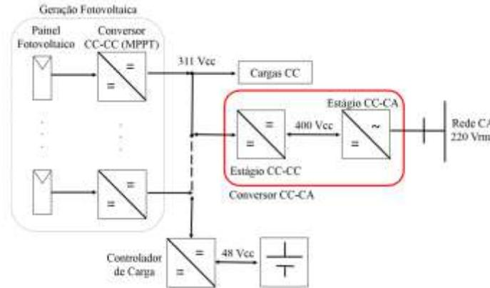
Figura 3 - Representação do sistema fotovoltaico proposto. Fonte: Adaptado de [9].
