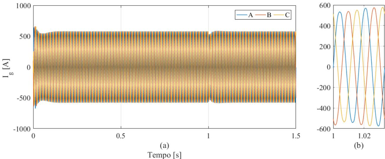
Figura 11 - Corrente de fase da rede injetada pelo MMC: (a) Performance no tempo; (b) Detalhe de (a) depois do instante 1s.
