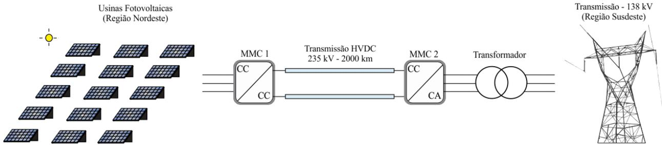
Figura 4 – Diagrama esquemático do sistema de transmissão em corrente contínua proposto.
