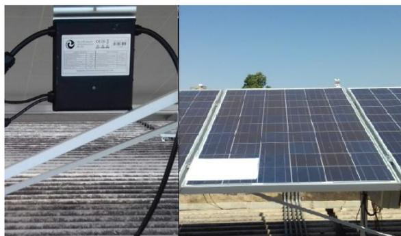
Figura 5– Sombreamento parcial realizado no módulo FV, o qual está conectado ao Microinversor.
