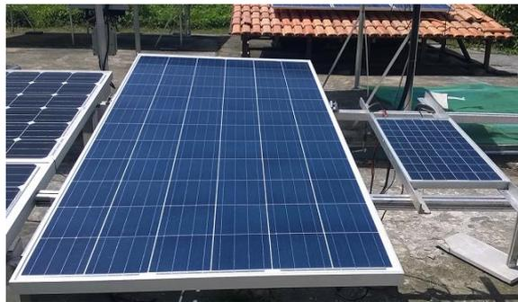
Figura 3 – Módulos sob teste e de referência posicionados para a realização do ensaio a sol-real.
