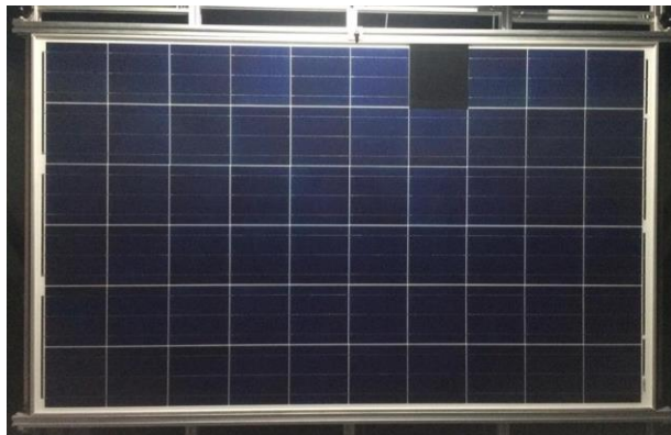
Figura 3 - M\u00f3dulo fotovoltaico com a c\u00e9lula 4 sombreada.
